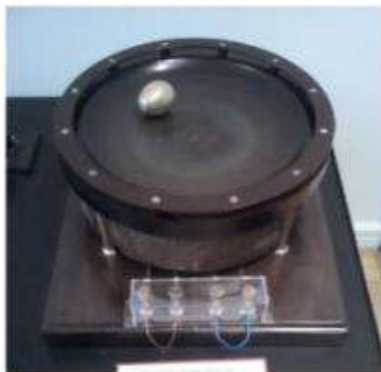
Slika 8. Teslin eksperiment „Kolumbovo jaje“ (indukcioni motor sa rotorom u obliku jajeta koje rotira u magnetnom polju) Muzej Nikole Tesle, Beograd
